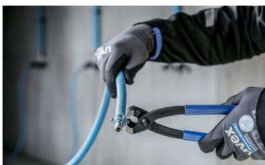
4. Posicionar abrazadera de dos orejas en la posición de prensado.
